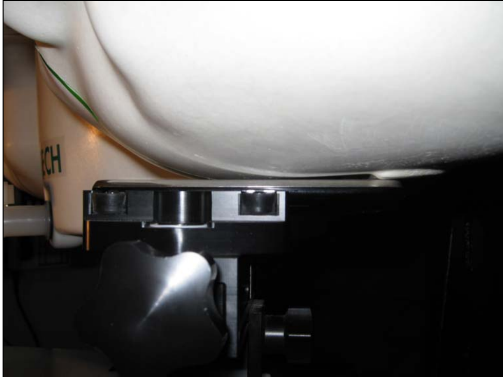
Fig. 20: Position joue sur le côté gauche du téléphone seul
