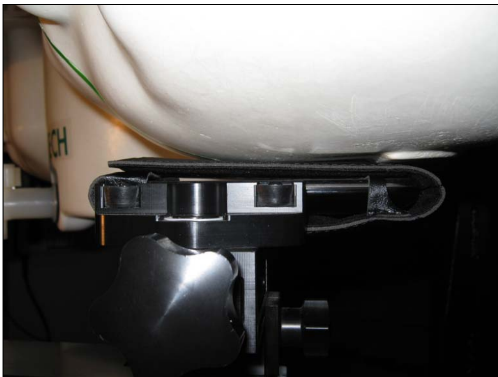
Fig. 21: Position joue sur le côté gauche du téléphone avec l'étui « anti-ondes »
