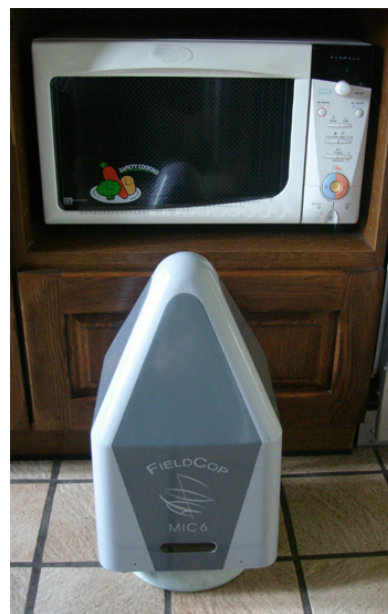
Analyseur de spectre FieldCop installé devant la porte du four à micro-ondes avec le film « RB » collé sur la fenêtre.
