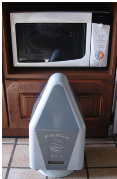
Analyseur de spectre FieldCop installé devant la porte du four à micro-ondes sans film « RB ».
