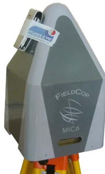
Sonde isotropique de l'analyseur de spectre « FieldCop » installée contre le portable rangé dans une housse ISOPHONE
