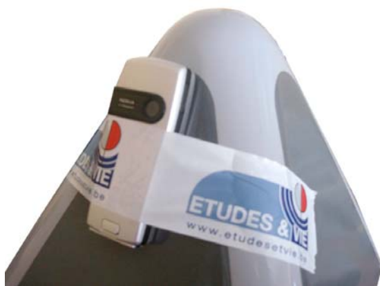
Sonde isotropique de l'analyseur de spectre « FieldCop » installée contre le portable
