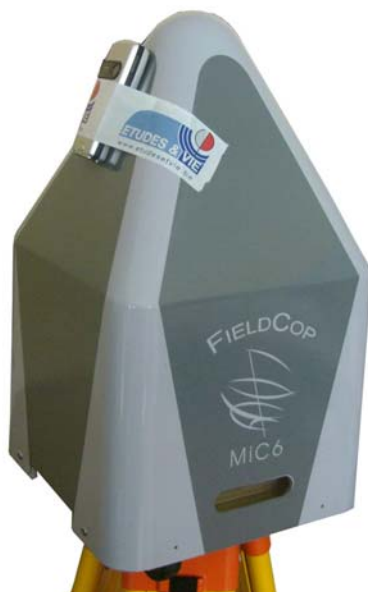
Sonde isotropique de l'analyseur de spectre « FieldCop » installée contre le portable
