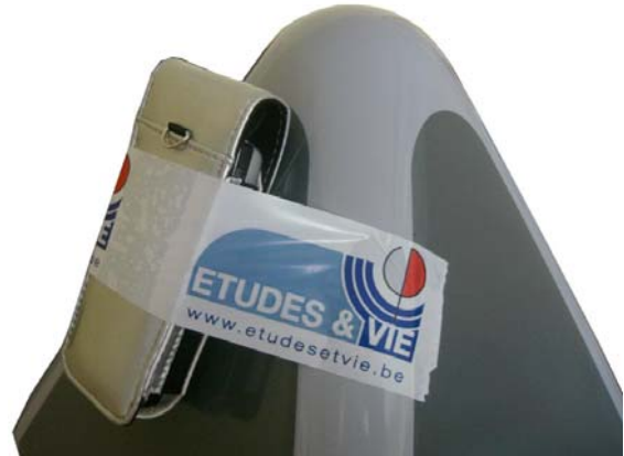
Sonde isotropique de l'analyseur de spectre « FieldCop » installée contre le portable rangé dans une housse ISOPHONE
