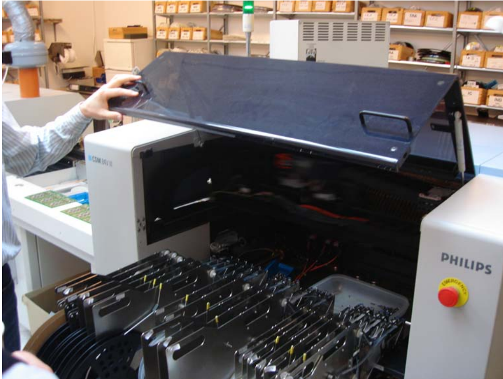
Robot destiné à assembler en série tous les composants électroniques sur les cartes électroniques
